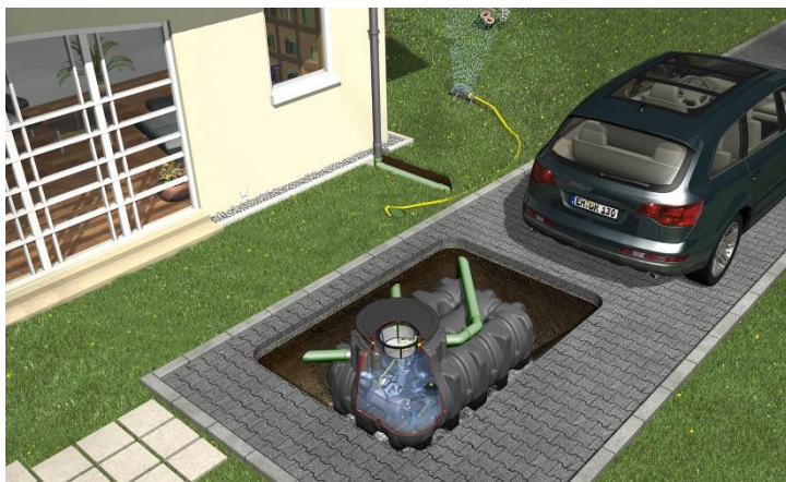
Abb. 4.1.4.13) Den Regenwassertank mit dem befahrbaren Schacht.
