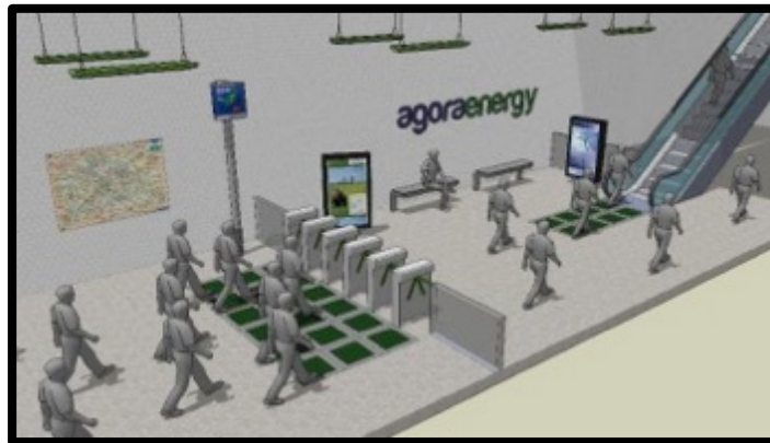
Figure 16 : Entrée de métro avec un sol piézoélectrique
