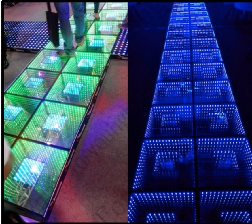
Figure 14 : Sol piézoélectrique prototype qui allume des LEDs
