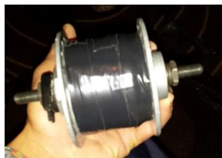
Rivestimento antislittamento (fig.11)
