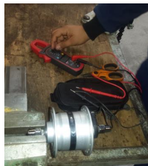
Test dinamo Gordola (fig.9)
