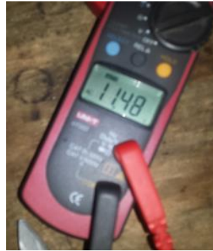
Tensione prodotto da dinamo (fig.8)
