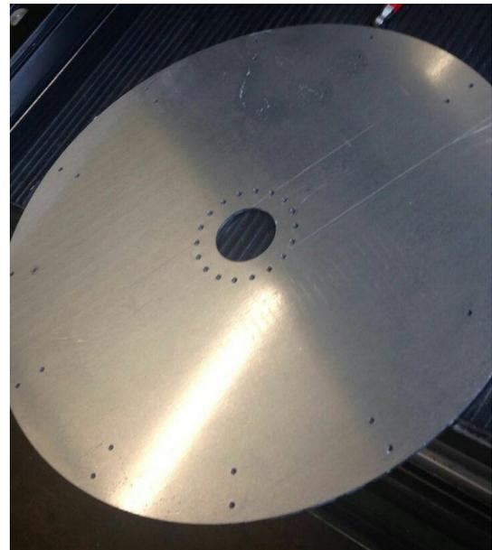
Abbildung 2 Scheibe für Wasserrad
