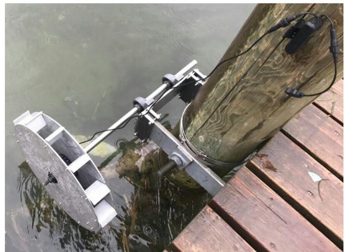
Abbildung 3 Montiertes Wasserrad
