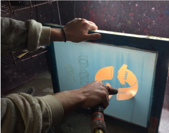
Bild 1: entschichten von Sieb (Herstellung Sieb)
