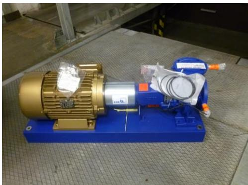
Hier wurde eine der neuen Wasserpumpenanlagen geliefert. Links (Gold) befindet sich der Motor der Pumpe. In der Mitte ist die Kupplung, welche auf die rechtsliegende Wasserturbine übergeht. Das Ganze befindet sich auf einer Grundplatte, auf welcher der Motor später ausgerichtet wird.
