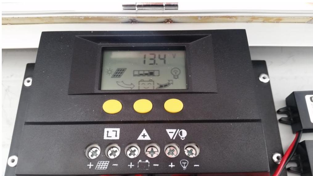
La videata rappresenta la carica della batteria e il livello di tensione (valore iconografico e valore reale, in questo caso 13.4V). La freccia a sinistra indica l'energia che dal pannello va a caricare la batteria, mentre la freccia a destra l'energia che dalla batteria va verso l'utilizzatore (porte USB).
