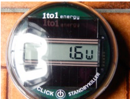
L'appareil en train de mesurer la consommation en mode veille
