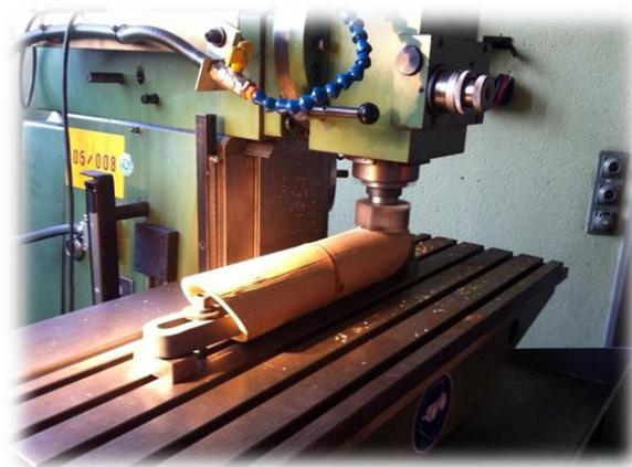
Als wir das hatten, haben wir auf der Unterseite des Bambusses eine Fläche über die ganze Unterseite weggefräst. (Bild)
