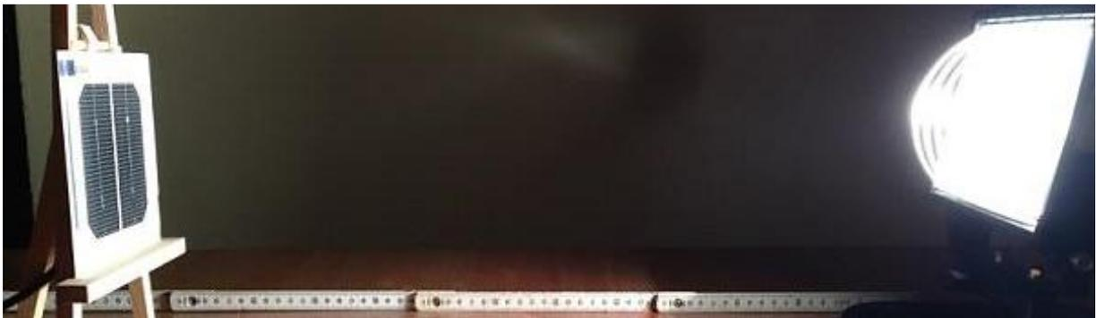
Bei unserer 1. Messung beträgt der Abstand zum Scheinwerfer 60cm. Der Winkel in dem das Licht auf die Solarzelle trifft, beträgt 90°.
