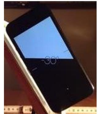
Bei unserer 2. Messung beträgt der Einfallswinkel des Lichtes nur noch 60°. Der Abstand zwischen der Solarzelle und dem Baustellenscheinwerfer ist und bleibt 60cm.
