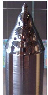
**Abbildung 25 - Ingot zur Waferherstellung**
