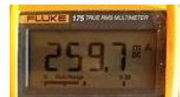
Wie uns der Versuch zeigt, ist die Leistung der Solarzelle durch die höhere Strahlungsintensität gestiegen. Auch dieser Versuch bewahrheitet also die Theorie. Der Stromfluss ist um beinahe 20% gestiegen. Der Grund warum die Spannung auch um ca. 7% gestiegen ist, liegt laut Markus Markstaler daher, dass das Messgerät einen Einfluss auf die Solarzelle nimmt.
