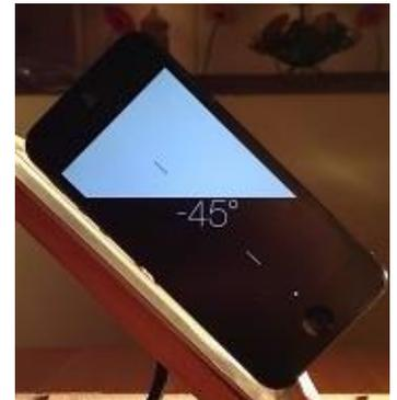
Bei unserer 3. Messung beträgt der Einfallswinkel des Lichtes noch 45°. Der Abstand zwischen der Solarzelle und dem Baustellen-scheinwerfer bleibt derselbe.
