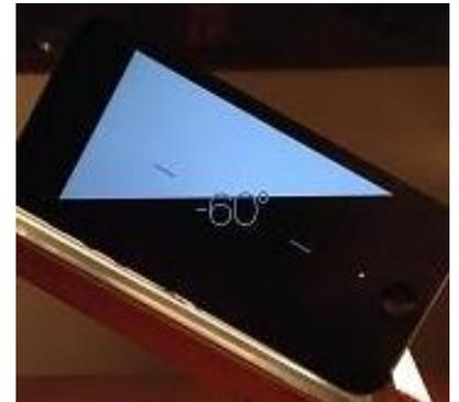
Bei unserer 4. Messung beträgt der Einfallswinkel des Lichtes noch 30°. Der Abstand zwischen der Solarzelle und dem Baustellen-scheinwerfer bleibt derselbe.
