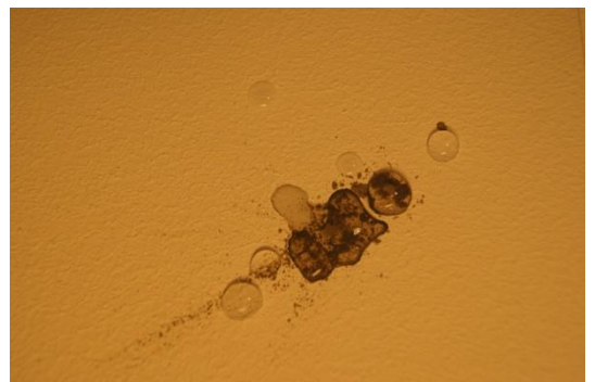
Abbildung 27: Fassadenprobe ohne Lotuseffekt: Wasser und Dreck
