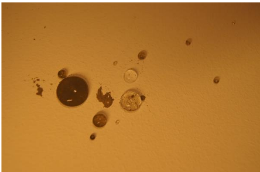
Abbildung 26: Lotuseffekt auf Fassadenprobe: Wasser und Dreck
