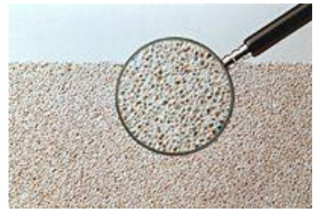
Abb. 3: Luftporen der Wärmedämmung (Ytong, 2003)
