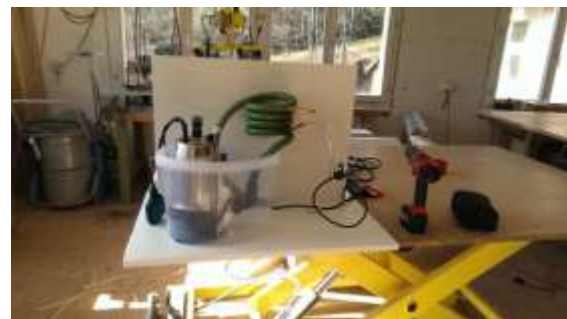
Abbildung 32: Zweiter Wärmetauscher in Bearbeitung
