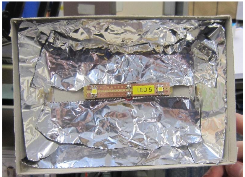
Abbildung 21 Mit Alufolie ausgekleideter Schirm/ Eingebaute LEDs
