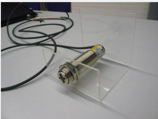
Abbildung 26: Halterung Laser fertig
