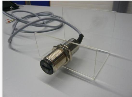
Abbildung 24: Halterung Tastsensor fertig
