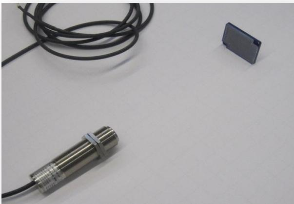
Abbildung 12: Laserreflex Lichtschranke
