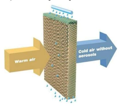
Die warme Luft wird durch einen Verdunstungs-Wärmetauscher herbeigeführt und durch das natürliche Prinzip der Verdunstungskälte wird der Luft extrem viel Wärme entzogen.
