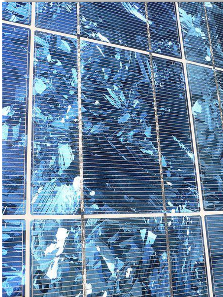
Abbildung 13 Solarzelle aus Silizium Quelle: http://de.wikipedia.org/wiki/Solarzelle
