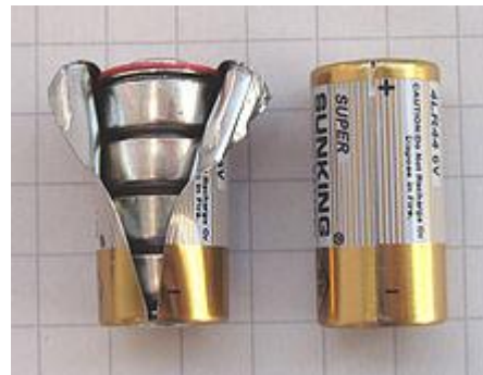
Abbildung 19 Batterie Innenleben Quelle: http://de.wikipedia.org/wiki/Batterie_(Elektrotechnik)
