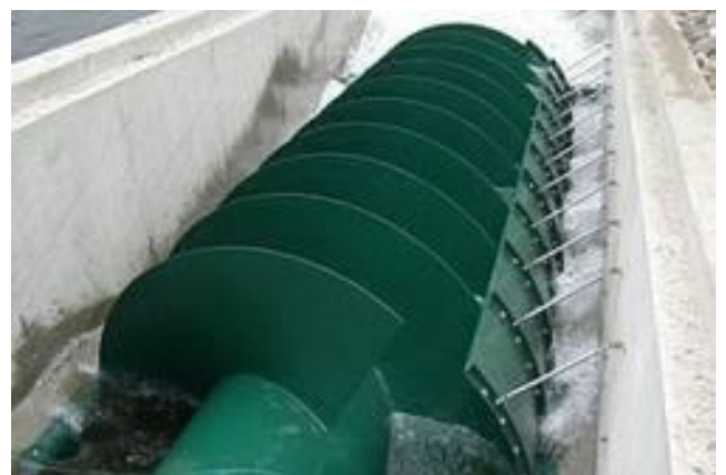
Abbildung 5 Schneckenturbine Quelle: http://www.roedhammer.at/index.php?id=465
