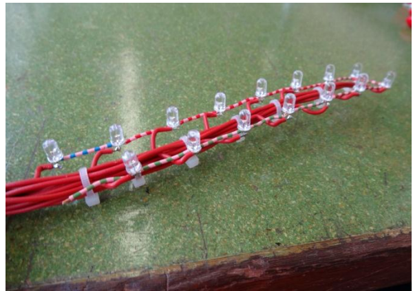
Abb. 7: Der fertige LED-Strang
