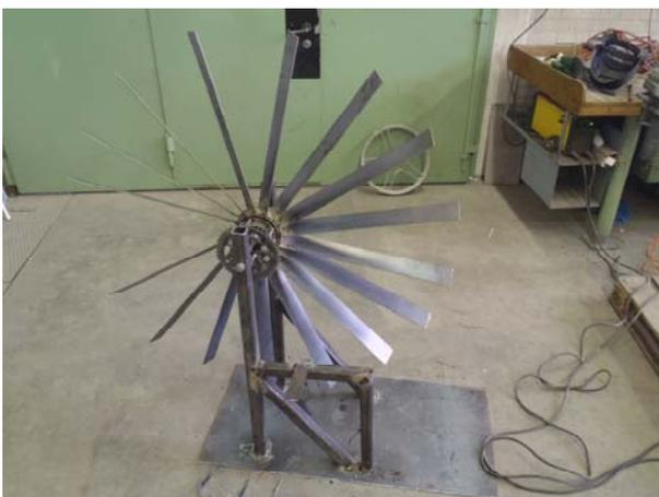
B9 Windrad mit geschweisster Stützkonstruktion
