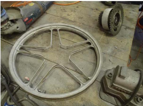
B1 Motorradfelge aus Al-Druckguss mit entfernter Nabe
