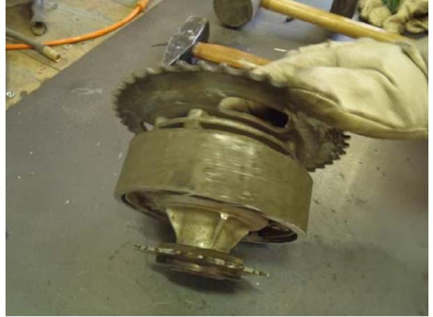
B4 aufgepresster Ring aus einem Rohrprofil
