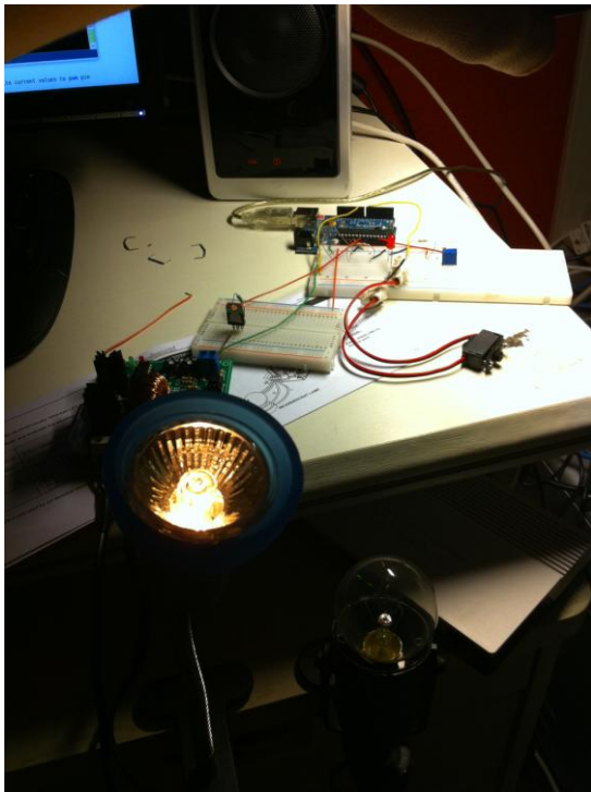
Der Lichtsensor ist beleuchtet. Die Lampe leuchtet wenig.
