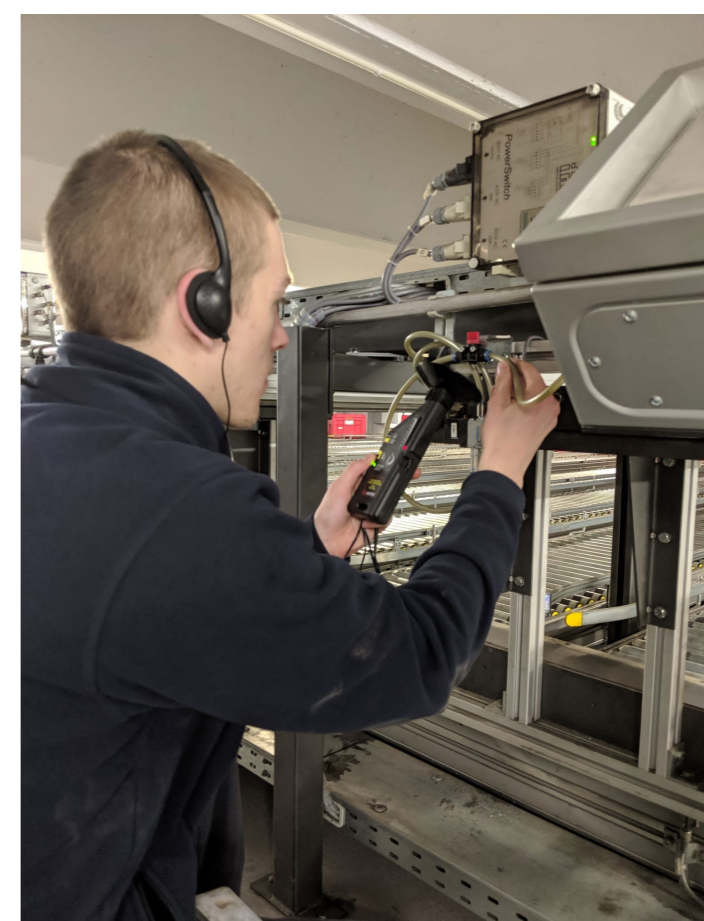
Leckage-Suche mit Ultraschall Hörgerät
