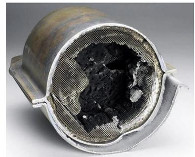
Figure 27 Filtre à particules bouché
