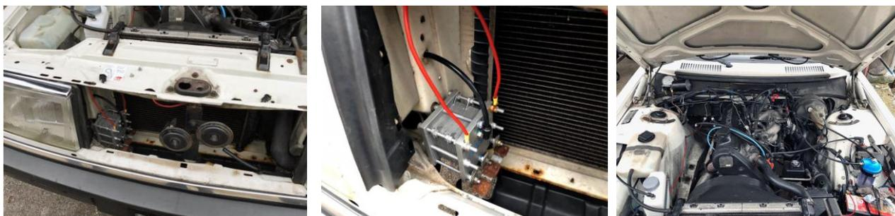
**Figure 30 Kit système HHO installé dans Volvo 940 de 1991. Tout ce qu'il faut c'est de la place. Le conducteur utilise ce système depuis 2 ans et sa voiture ne date pas de hier**
