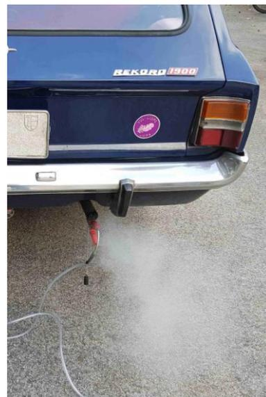
**Figure 29 :** Opel rekord avec une mauvaise combustion. Premier l'essai avant le décarbonisation. La formation de la brume d'eau et de gaz d'échappement
