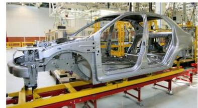
**Figure 5** Un châssis d'une voiture matricé en aluminium
